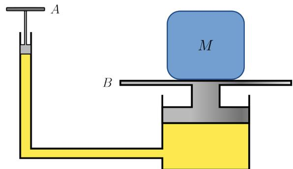
Sem a presença do bloco de massa  $M$  na plataforma  $B$  o sistema está em equilíbrio. É necessário aplicar uma força vertical  $F = 200$  no pistão  $A$  para elevar o bloco apoiado na plataforma  $B$  com velocidade constante. Determine:
